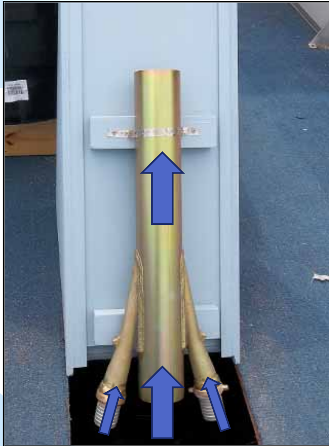
Water jet (venturi)
