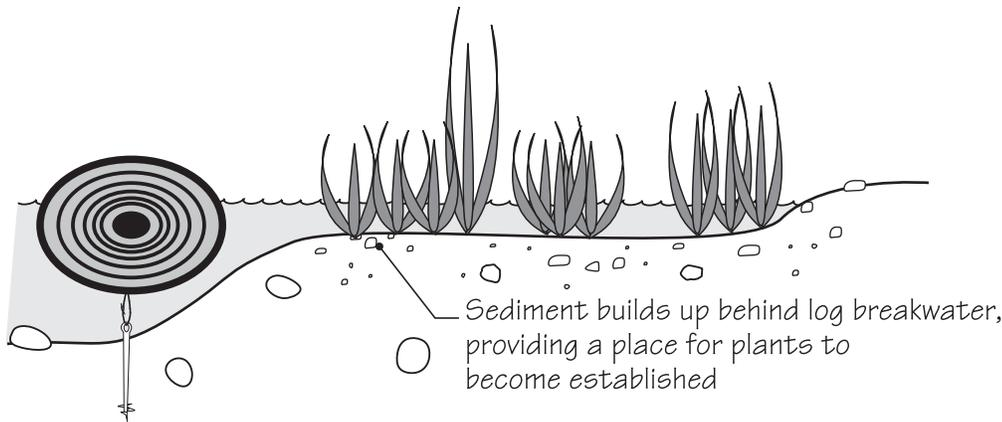
**LOG BREAKWATER: SECTION VIEW**
